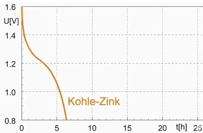
Abb. 5: Spannungsverlauf bei der Entladung einer Zink-Kohle-Batterie bei gleicher Größe wie eine Alkaline-Batterie. Konstanter Entladestrom von 120 mA. 2
